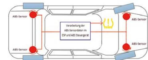
Sowohl bei den direkten als auch bei den indirekten Systemen werden die Fahrer bei Druckverlust in den Reifen durch Aufleuchten der Reifendruck-Warnleuchte gewarnt.
